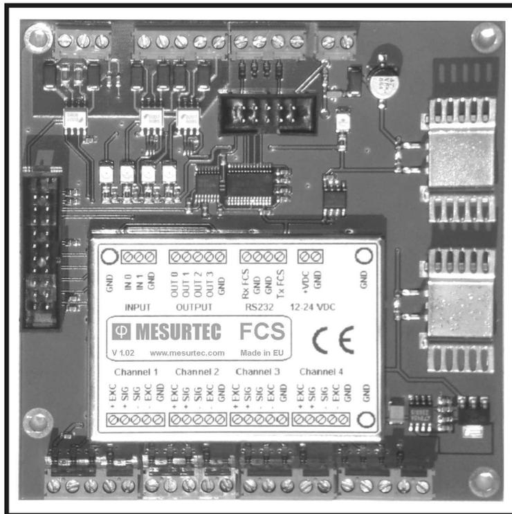
Photo : Modèle numérique OEM-FCS avec 4 canaux et l'option I/O pour du dosage sans montage rail DIN
