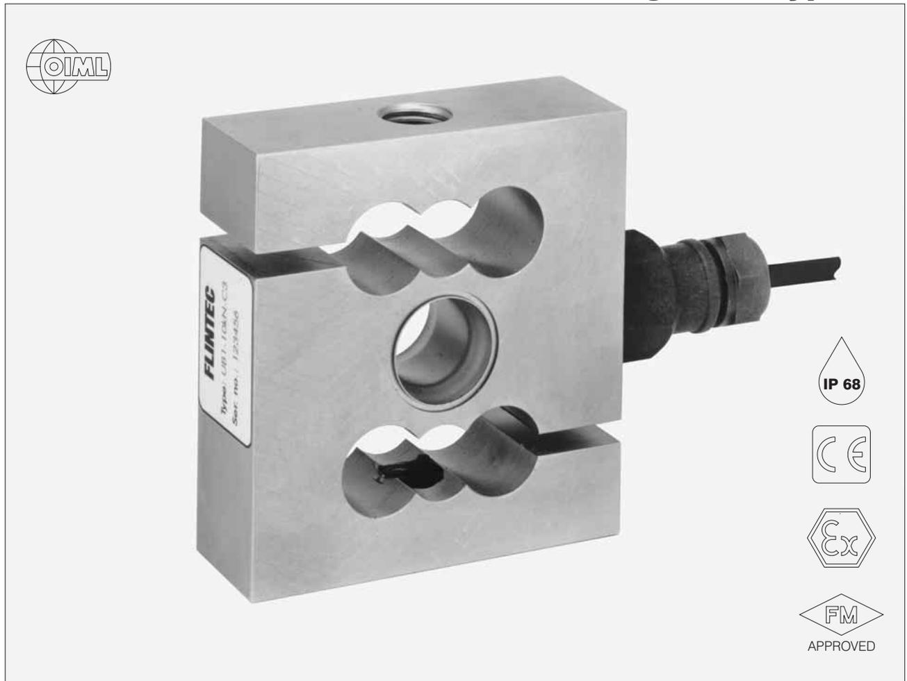
Die UB1 Wägezelle ist in Nennlasten von 10 kN bis 50 kN (1020 kg bis 5099 kg) und in den Genauigkeitsklassen GP, C1 und C3 verfügbar.
