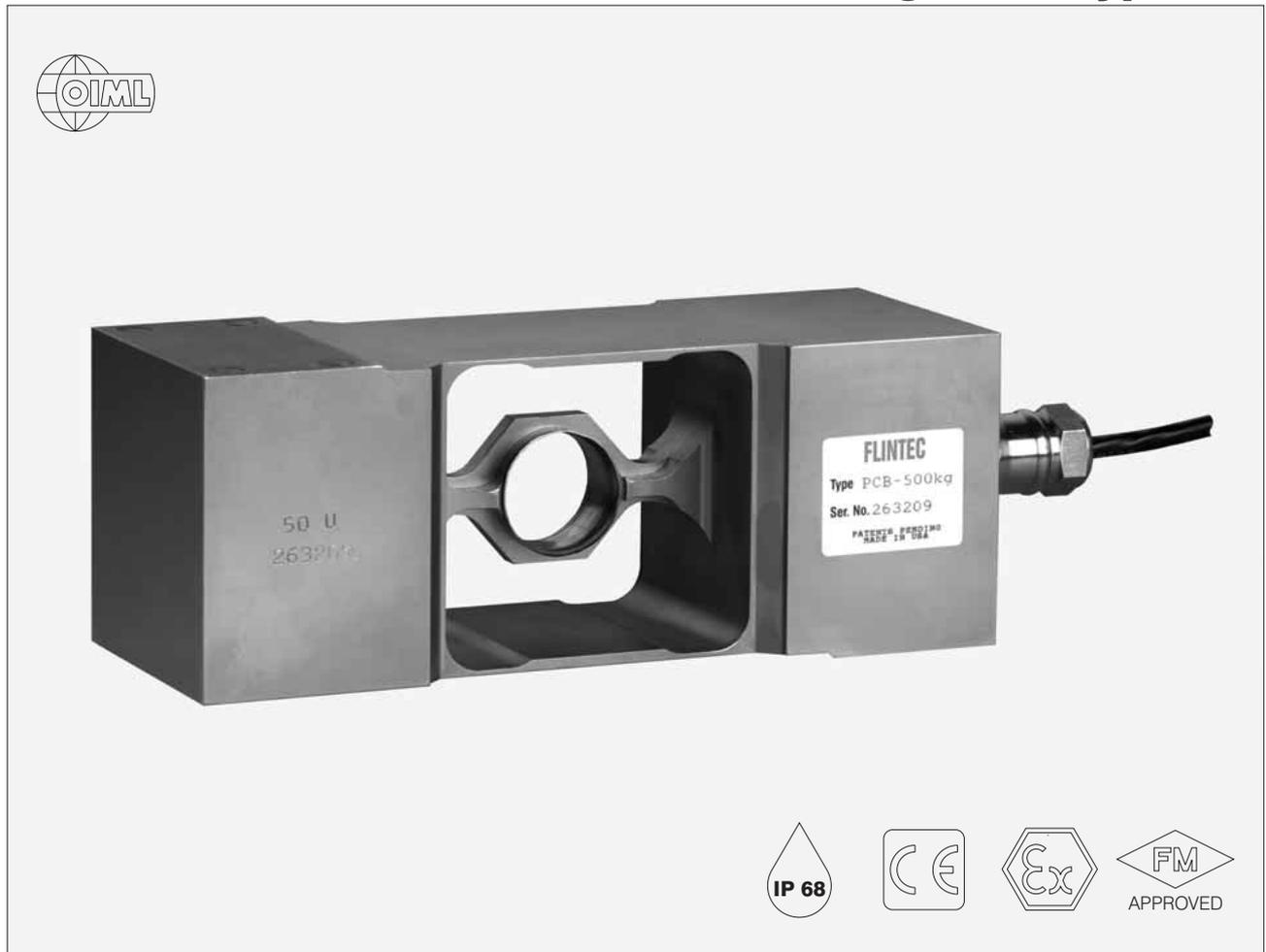
Die PCB Wägezelle ist in Nennlasten von 50 kg bis 1000 kg und in den Genauigkeitsklassen GP, C3 und C3 MI 6 verfügbar. Die C3-Version entspricht den Anforderungen für eichpflichtige Waagen der Eichklasse III bis 3000 d Auflösung, gemäß OIML R 60.
