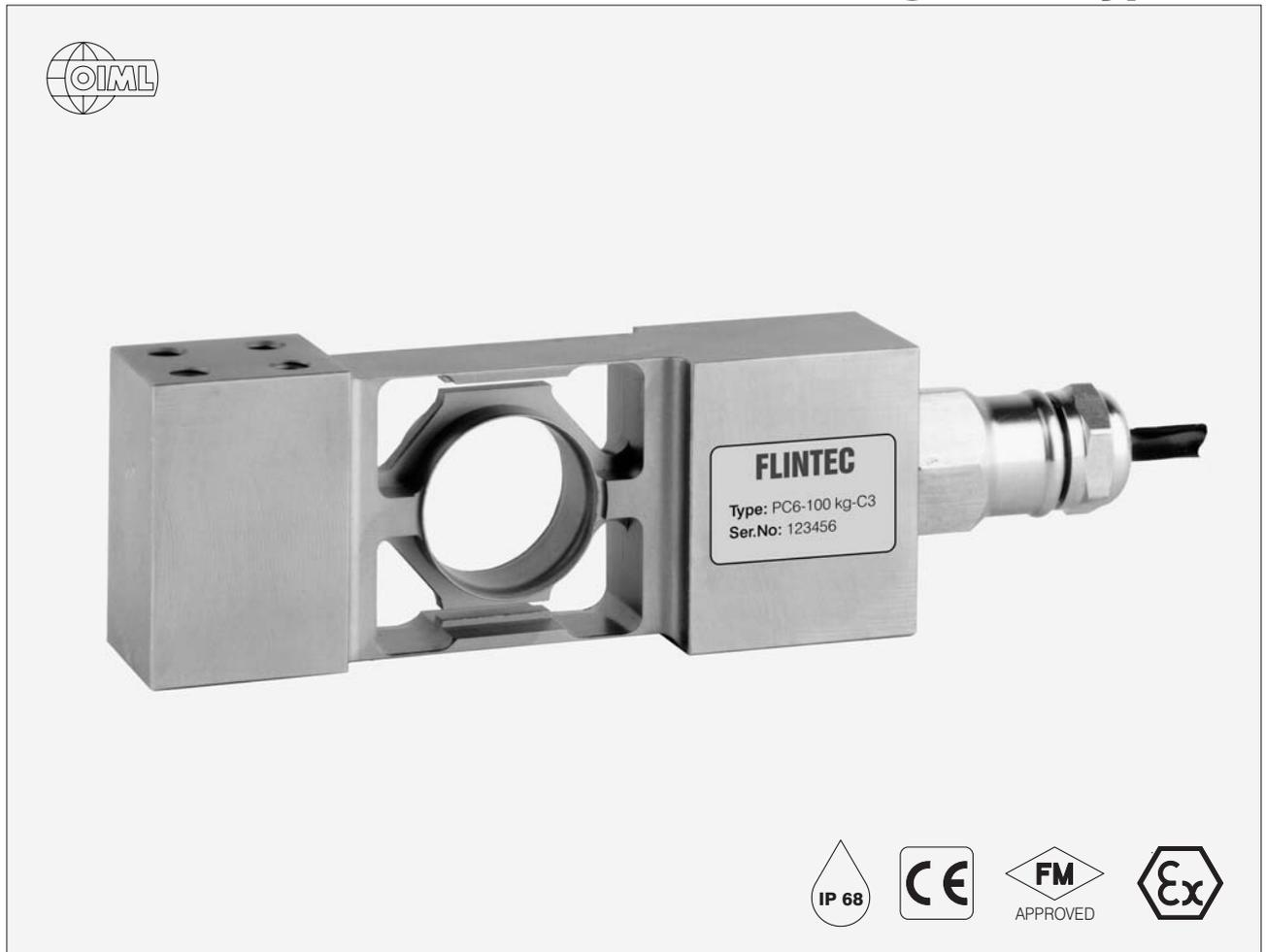
Die PC6 Wägezelle ist in Nennlasten von 10 kg bis 200 kg und in den Genauigkeitsklassen GP, C3, C3 MI 6, C3 MI 12 und C4 verfügbar.
