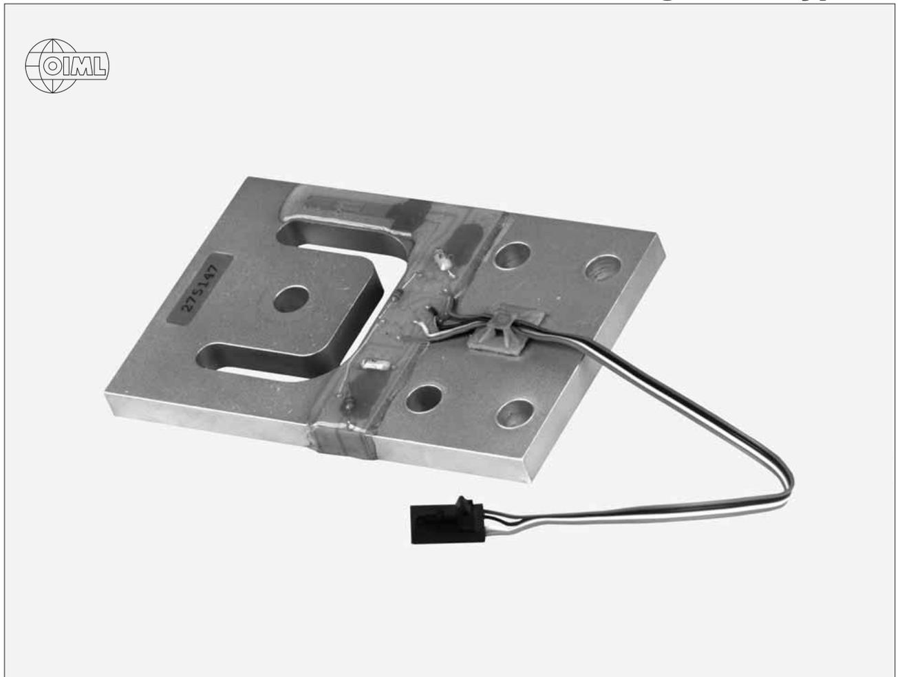
Die PB Wägezelle ist in Nennlasten von 3.75 kg bis 375 kg und in den Genauigkeitsklassen GP und C3 verfügbar. Mit diesen Nennlasten sind Waagen im Bereich 6 bis 600 kg zu realisieren. Die C3-Version entspricht den Anforderungen für eichpflichtige Waagen der Eichklasse III bis 3000d Auflösung, gemäß OIML R60.
