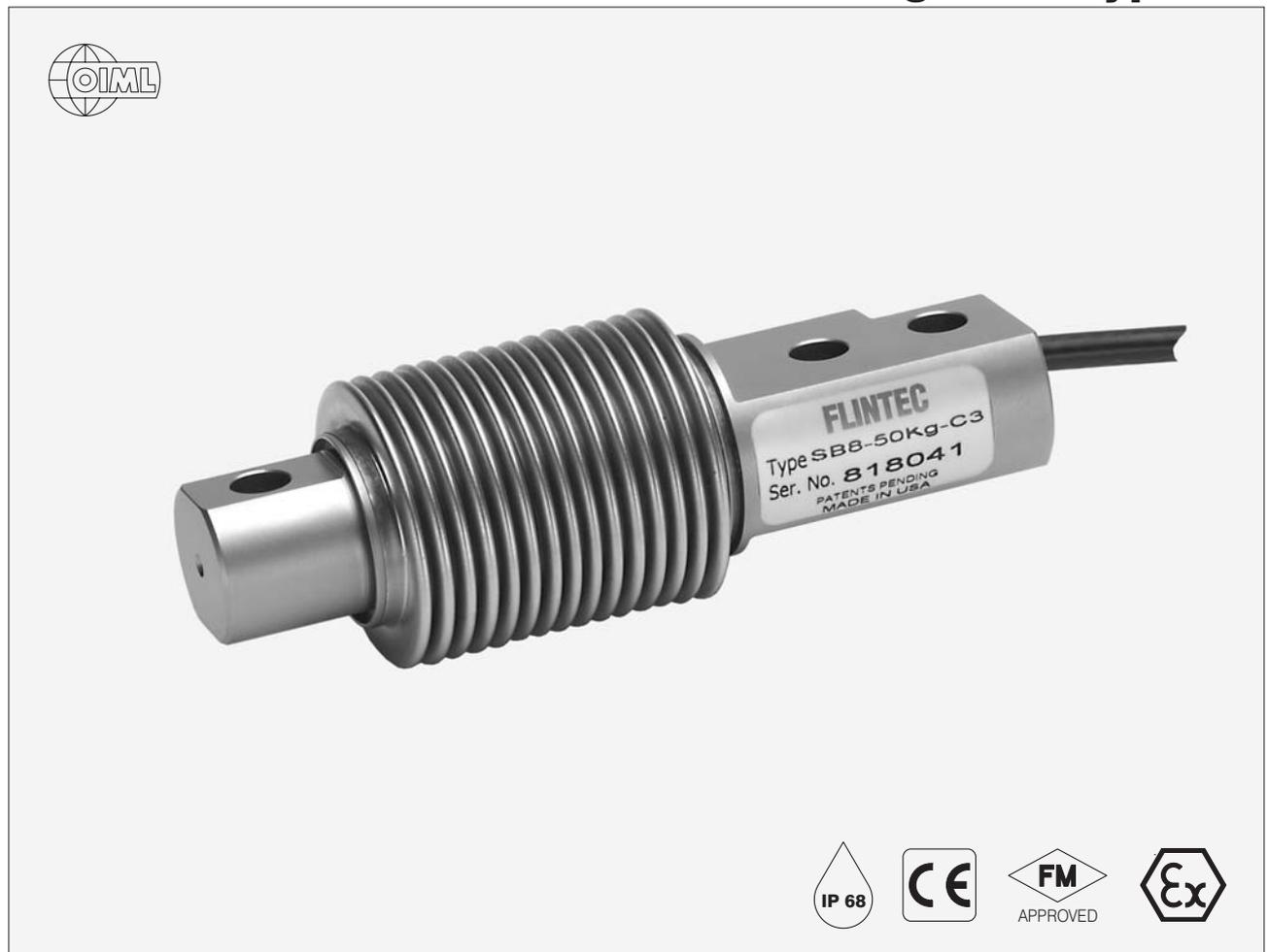
Die SB8 Wägezelle ist in Nennlasten von 10 kg bis 500 kg und in den Genauigkeitsklassen GP, C1, und C3 verfügbar.
