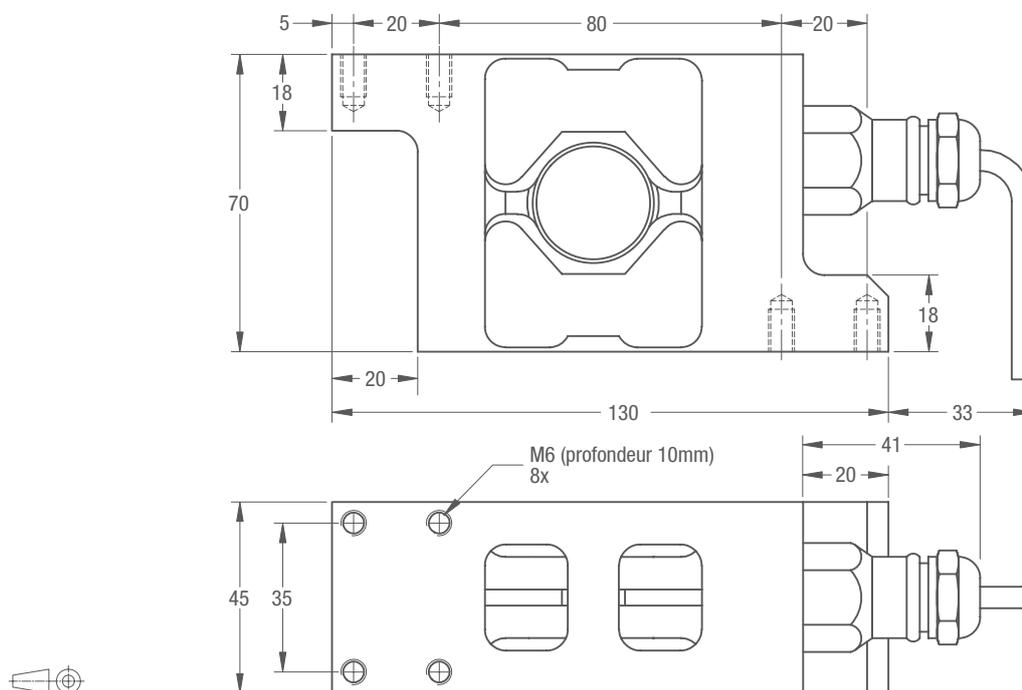
Vis de montage M6 8.8; Moment de serrage 10 Nm. Graisser les filetages avant montage.
