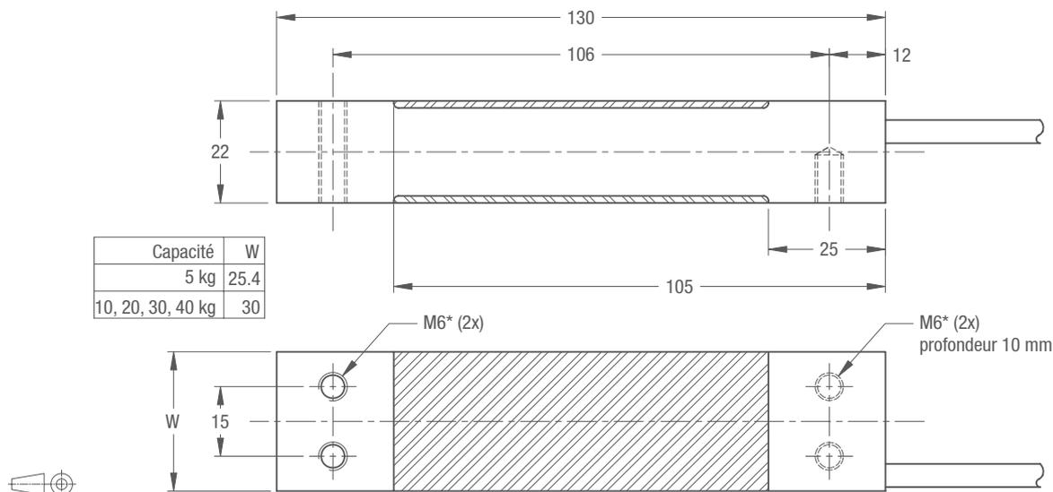
Vis de montage M6 8.8; Moment de serrage 10 Nm. Graisser les filetages avant montage.
